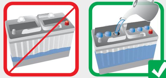
Compruebe siempre el nivel de agua de la batería. Utilice solamente agua destilada.
