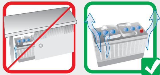
¡La batería necesita aire, guárdela en un sitio ventilado!
