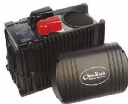
El inversor / cargador de onda senoidal pura de OutBack es una solución completa de energía. Incorpora un inversor de onda pura, cargador de batería y un interruptor de transferencia de CA alojados dentro de un chasis de aluminio fundido a presión. El Inversor / cargador Serie VFXR ofrece la posibilidad de vender electricidad solar a la red eléctrica al mismo tiempo que proporciona energía de reserva instantánea en caso de una interrupción en la red pública.
