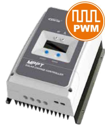
La serie de controladores de carga Tracer MPPT es la línea más avanzada de controladores ofrecidos por EPEVER. La tecnología MPPT permite maximizar la energía que entregan los paneles solares a las baterías, obteniendo hasta un 30% más de energía respecto a controladores tipo PWM. Además los controladores cuentan con control programable de encendido y apagado automático de la carga, por lo que pueden operar como un reemplazo directo de un controlador PWM.
