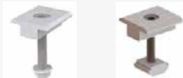
**Grapa intermedia:** Sólo es requerida en sistemas con 2 o más módulos. La medida de la grapa deberá ser igual a la altura del marco del panel solar a instalar. Con tuerca bridada (Horizontales) o Con tuerca especial (Sistemas con rieles).
