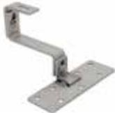
**Ancla para fijación a cero grados:** Se usa para techos de madera o concreto con teja española. Se incluyen pijas autorroscantes para techos de madera y taquetes expansivos de 1/4".
